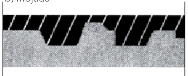
Dibujo N° 2. Mojado de un sustrato sólido por un adhesivo fluido
